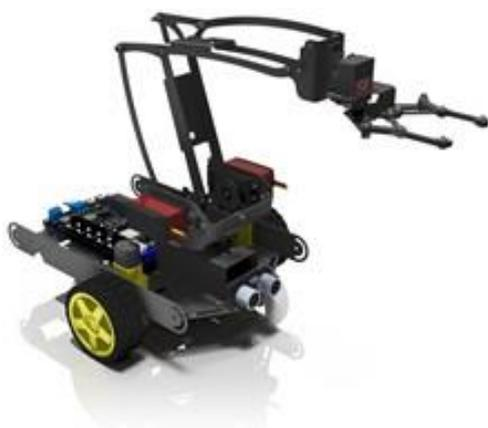
В состав комплекта входит набор электронных компонентов для изучения основ электроники и схемотехники, комплект приводов и датчиков различного типа для разработки робототехнических комплексов, а так же модуль технического зрения для распознавания заранее заданных графических объектов. Комплектующие и устройства набора обладают конструктивной, электрической, аппаратной и программной совместимостью друг с другом.
